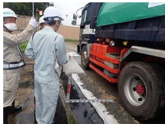
輸送車両の空間線量率測定
