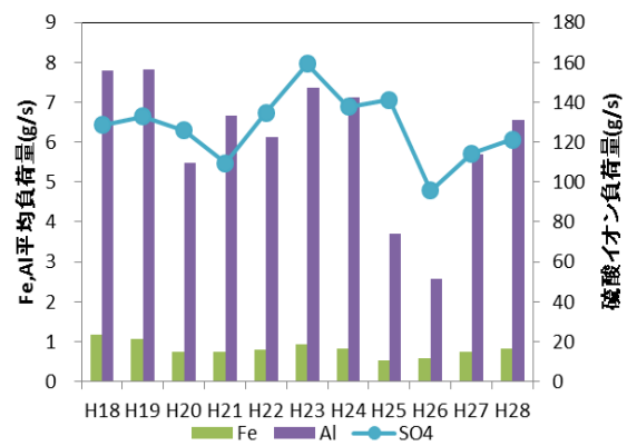
図 29 ④ 酸川(高森川合流前)の酸性成分負荷量及び流量の経年変化
