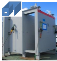
①150mmの鉄板を用い渦巻き形状の遮へいBOXを設置
