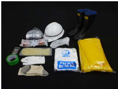
防護装備一式 (ヘルメット、マスク、布手袋、ゴム手袋、防護服、靴下、長靴、アノラック、個人被ばく線量計、養生テープ等)
