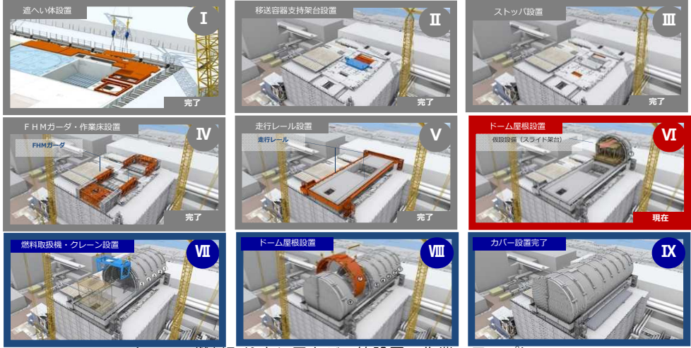
<1-22. 燃料取り出し用カバー等設置の作業ステップ>
