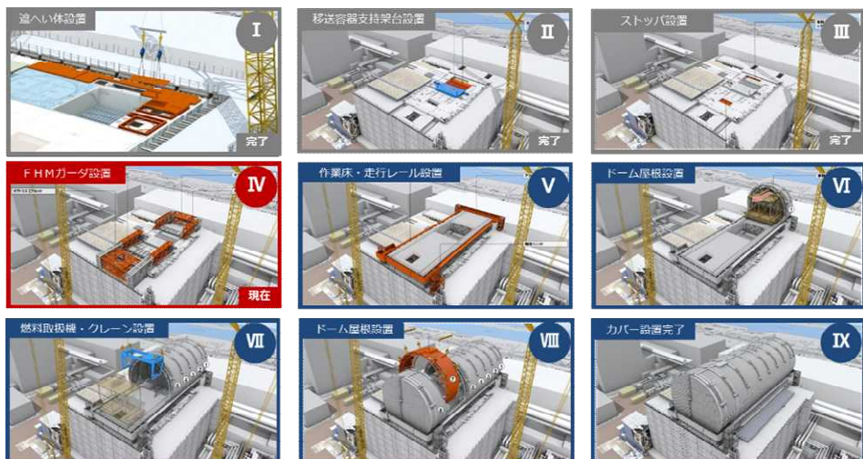
<5-1. 燃料取り出し用カバー等設置の作業ステップ>
