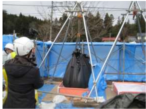
チェンブロックによる吊り下げ (下には接地しないようにプールを配置)
