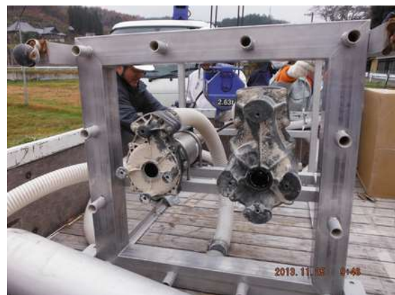
底質攪拌装置（底部） 左が揚水用でもう右が攪拌用。攪拌用で吸い込んだ水をフレームから噴射させる
