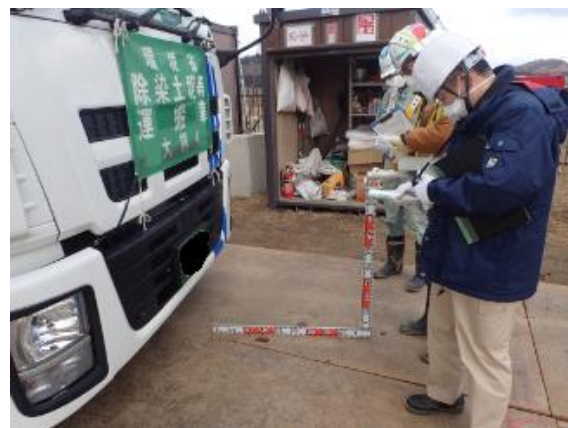
輸送車両の空間線量率確認
