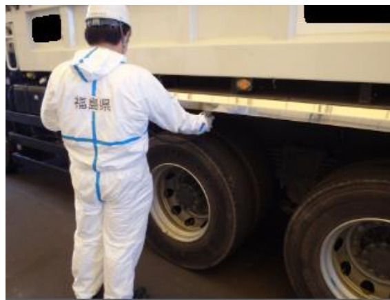
保管場からの退場車両の線量測定
