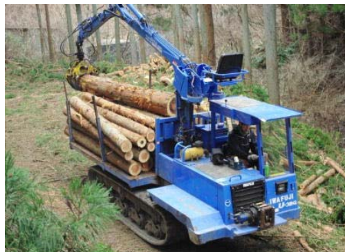
林内作業路整備支援事業により開設した 作業路を利用した間伐材の搬出（いわき市）
