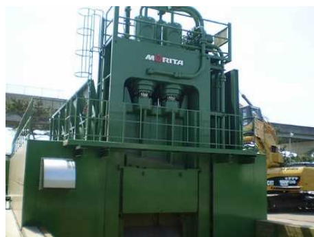
減容処理設備 金属切断機（例）
