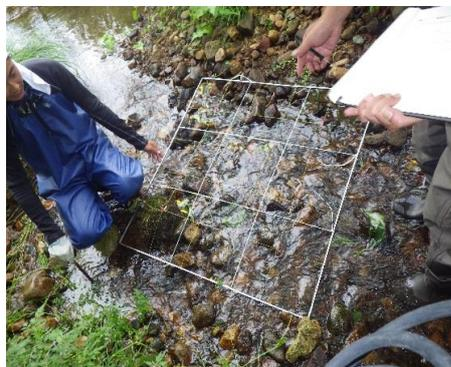
図3 方形枠を用いた河床調査
