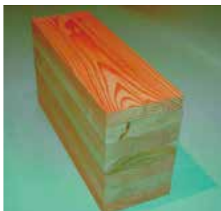
写真5-23 外層にカラマツ、内層にスギを用いたハイブリッド集成材
