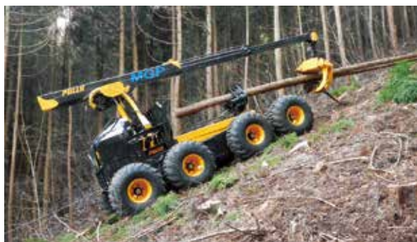
写真5-3 リモコン操縦でマルチスキッドのクレーンを操作して材を集めます。 幅2.56m×長さ4.72m、車体重量4.75tの8輪、100馬力(ディーゼル)
