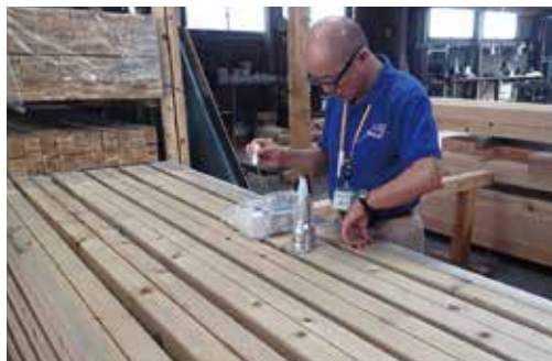
写真5-8 木材の表面線量測定状況
