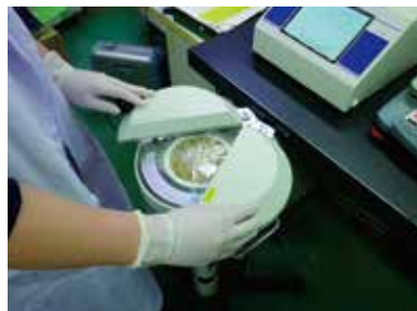
写真5-34 放射線測定器（NaI（TI）シンチレーションスペクトロメータ）を活用した放射線の測定検査
