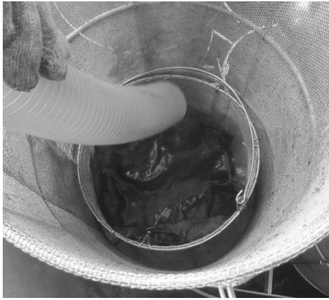
図-10 プルシアンブルー染色ウールによるろ過
