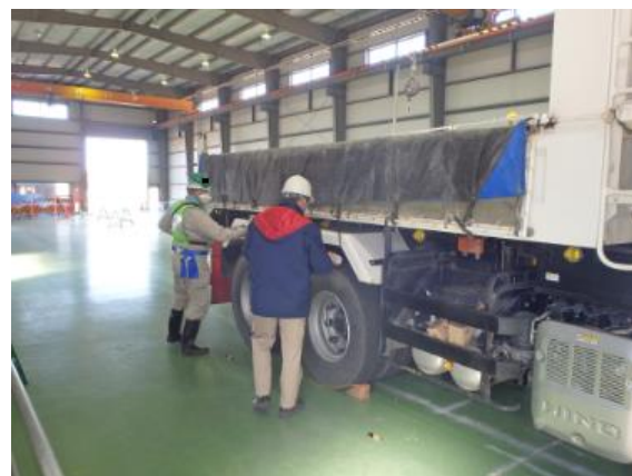
保管場からの退場車両の線量測定
