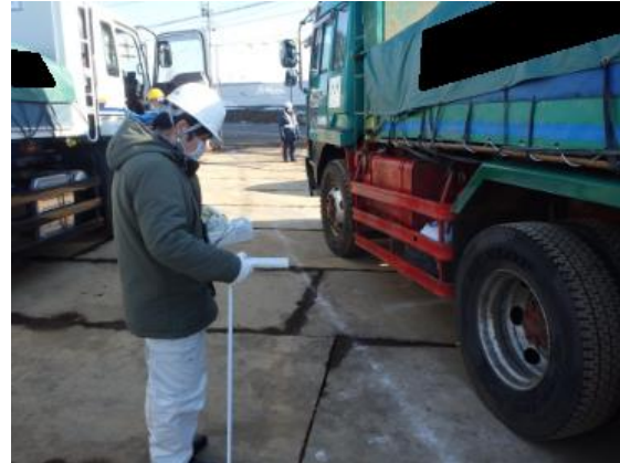
輸送車両の空間線量率の測定
