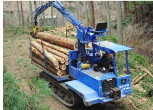
林内作業路整備支援事業により開設した 作業路を利用した間伐材の搬出（いわき市）
