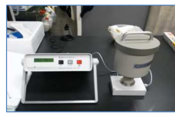
持ち込まれた食品等の放射性物質を検査
