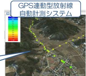
100m程度の間隔で測定している各測定点が周囲の状況とともに確認可能。測定器35台導入。
