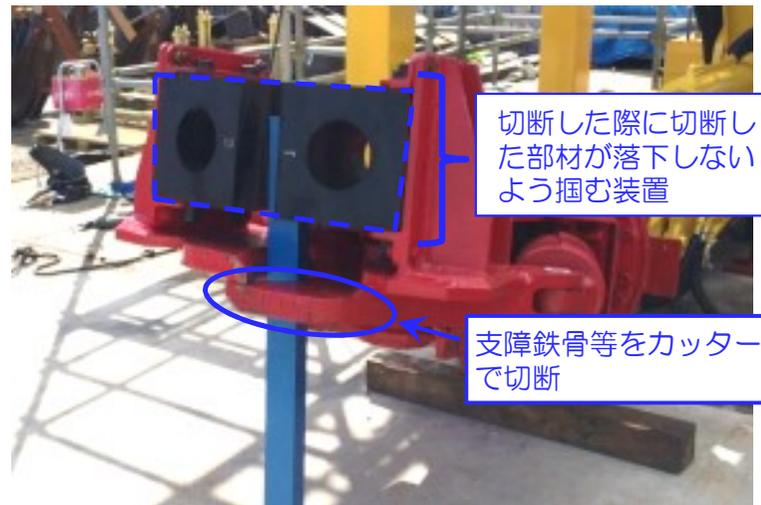
切断した際に切断した部材が落下しないよう掴む装置
