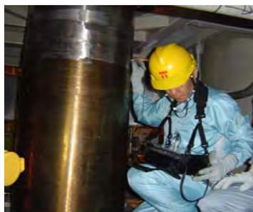
超音波探傷試験の状況
