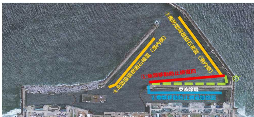
①、②の効果が認められない場合は、東波除堤周辺のテトラポッド内隙間充填・閉塞等追加対策を検討 (②')
