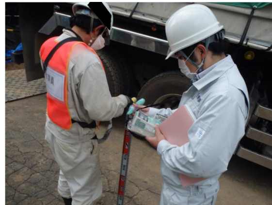
運搬車両の空間線量率の測定
