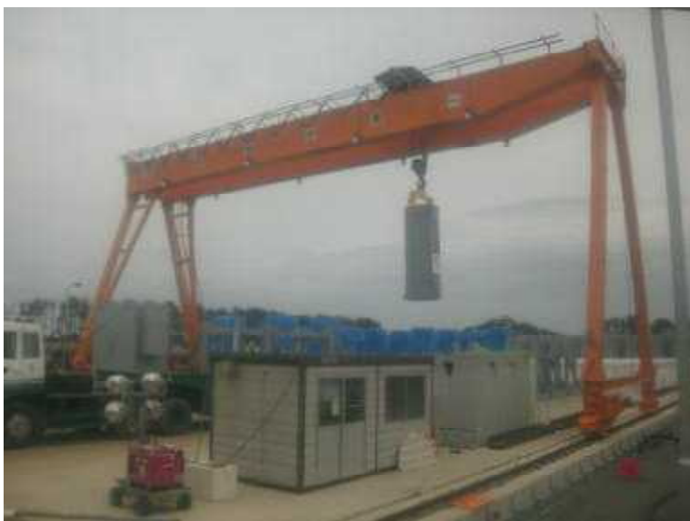
使用済ベッセル(サリー)の移動 〔使用済ベッセル保管施設〕
