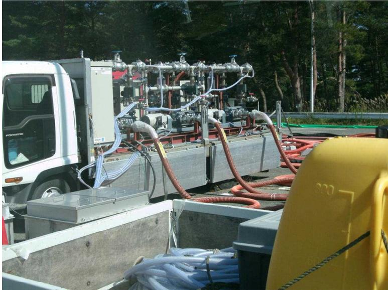
1～3号機の炉注水ポンプの代替品
