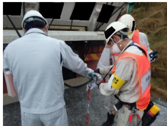
運搬車両の空間線量率の測定
