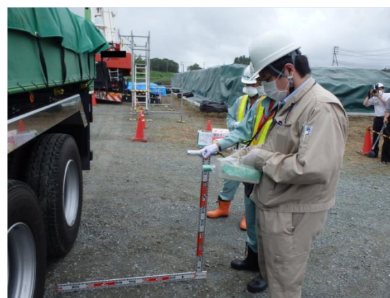
運搬車両の空間線量率の測定
