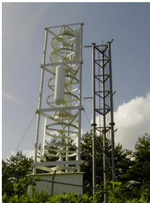
図 4.3-1 垂直軸型の小形風力発電システム
