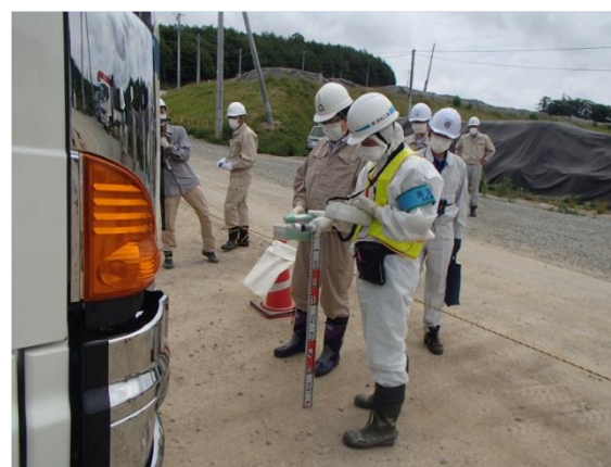
運搬車両の空間線量率の測定
