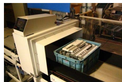
金属探知機によるPCカバーの異物確認工程
