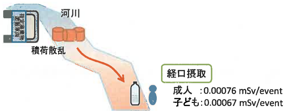
図 5-4 特定廃棄物等の運搬時の事故に伴う被ばく線量(シナリオ 3 : 経口摂取)
