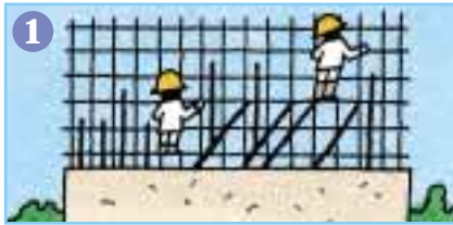
1 鉄筋の組み立て 鉄筋を組み立てて、ケーソンの骨組をつくります。
