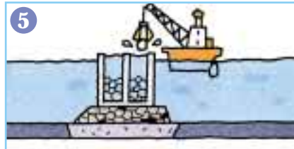
5 中詰め材を入れる 据え付けたケーソンの中に砂や石をつめます。
