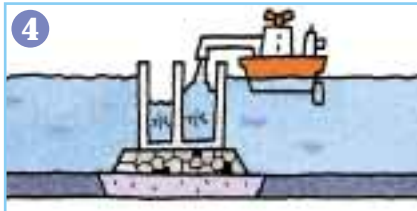
4 据え付け ケーソンの中に水を入れ、基礎の上に乗せます。
