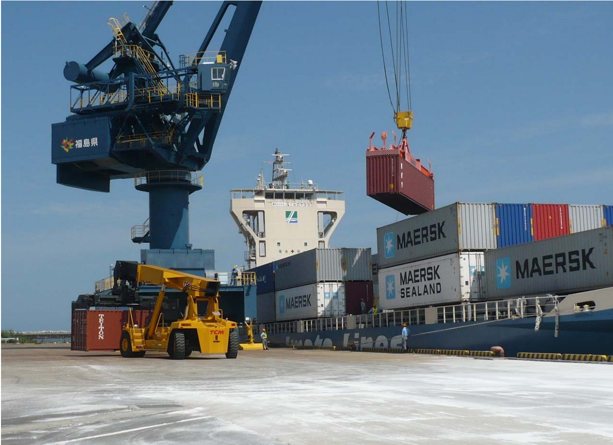
2-3バース 多目的クレーンによるコンテナ荷役作業
