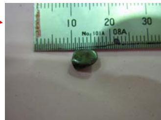
粒状の金属片 (約6mm × 約5mm × 約3mm)
