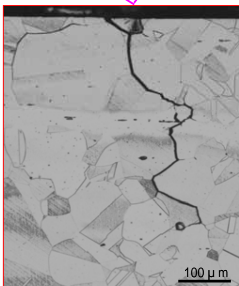
粒界に沿って発生したひび (断面図)
