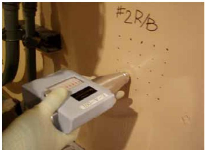
原子炉ペDESTALのシュミットハンマー法による強度確認
