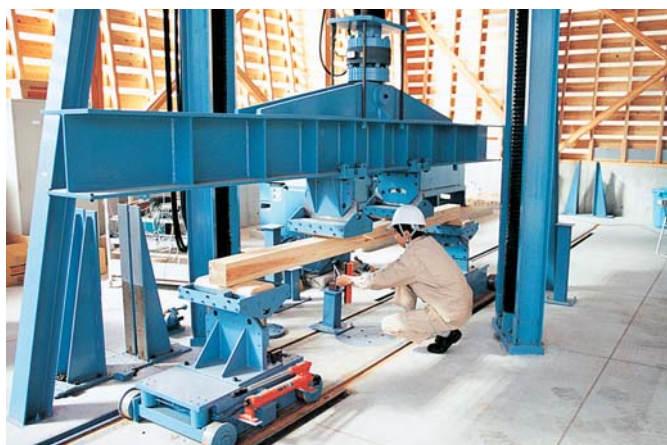
スギ柱材曲げ試験（郡山市・林業研究センター）
