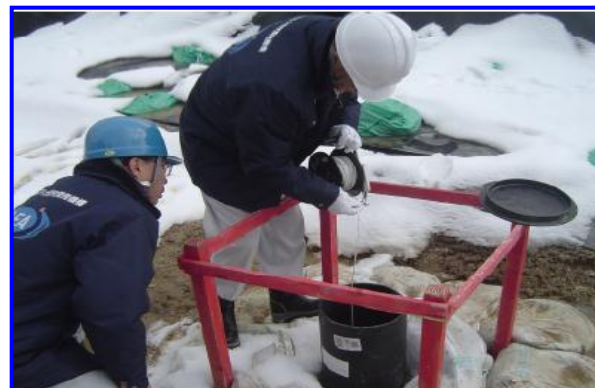
地下水位観測及び採水
