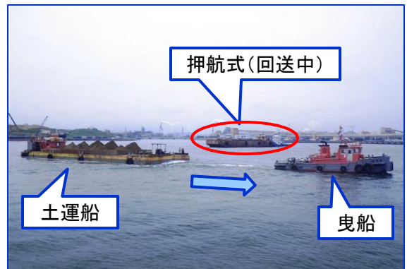
土運船運搬状況（曳航式）
