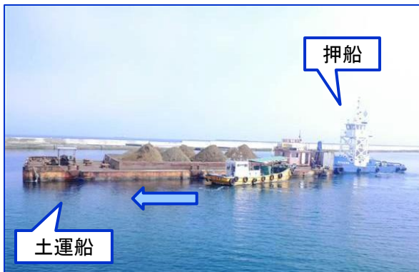
土運船運搬状況（押航式）
