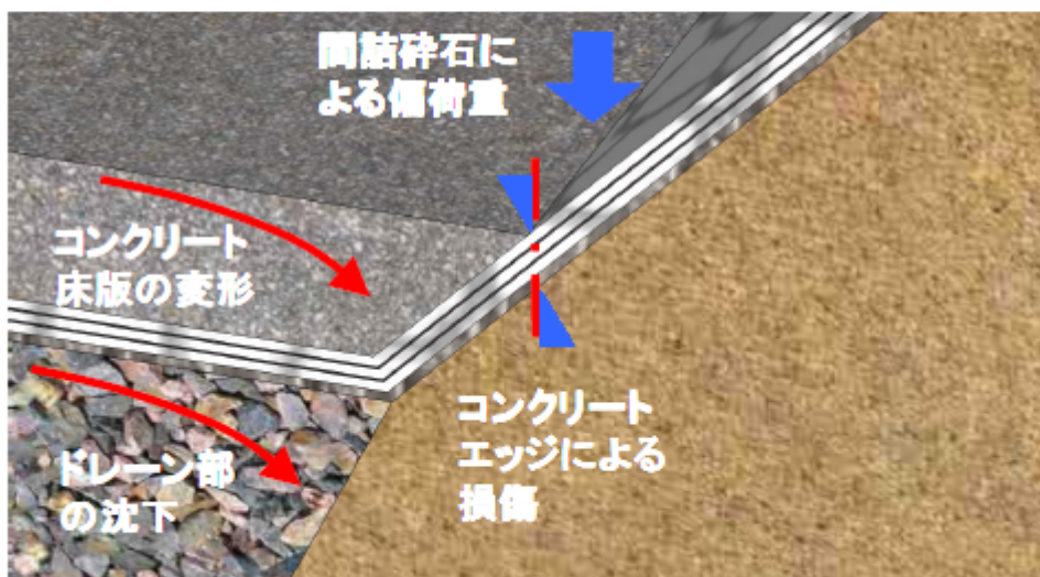
コンクリートエッジにおける損傷メカニズム (想定)
