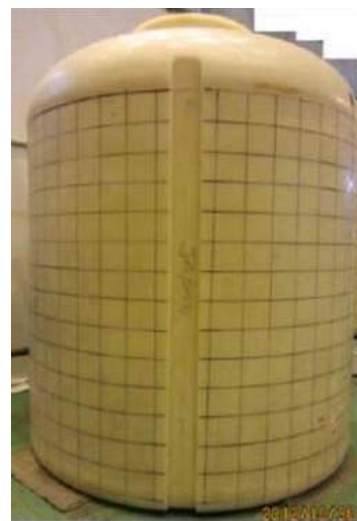
補強リング取り外し後
