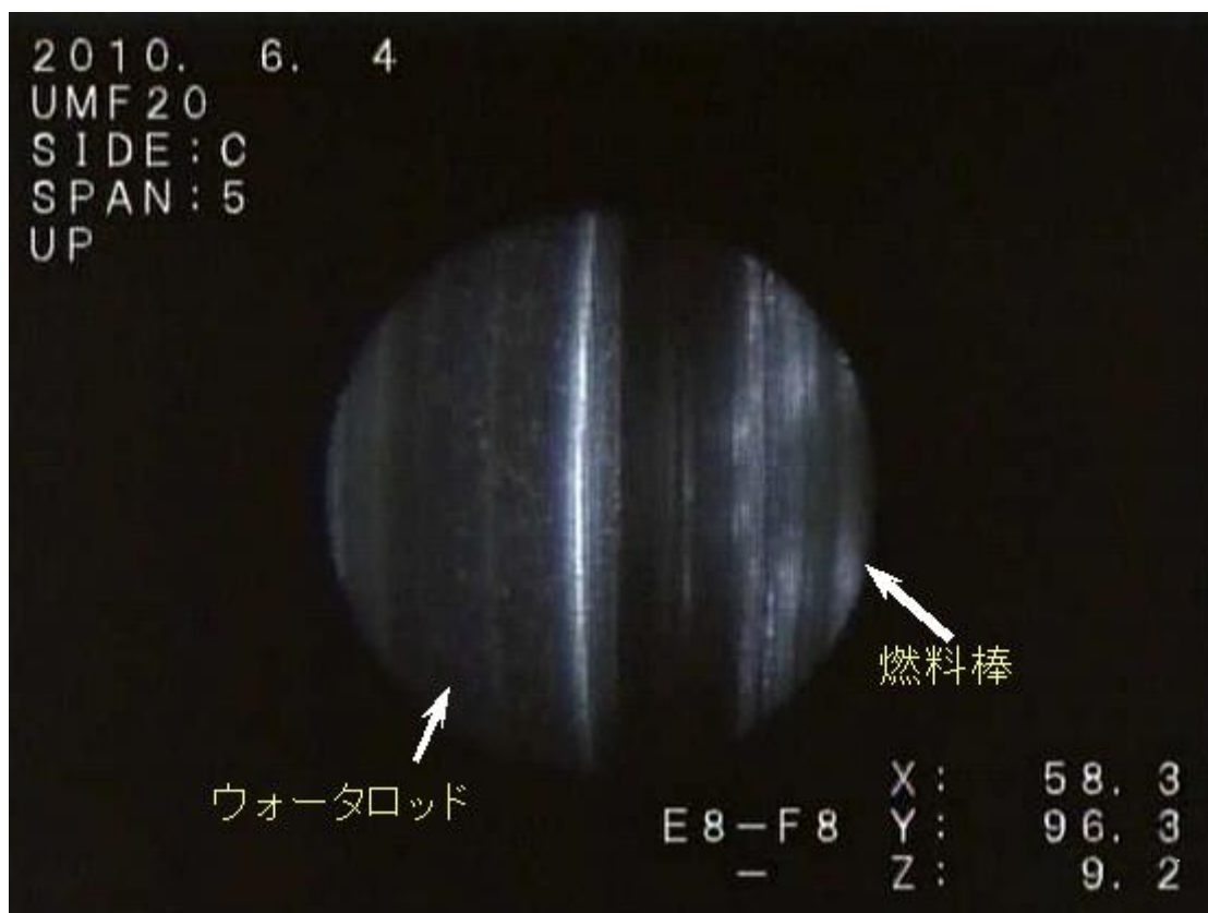
図3-4 ファイバースコープ観察例(直視視野)
