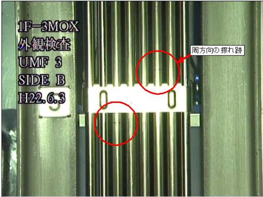
図1-1 UMF3外観確認結果(周方向の擦れ跡)
