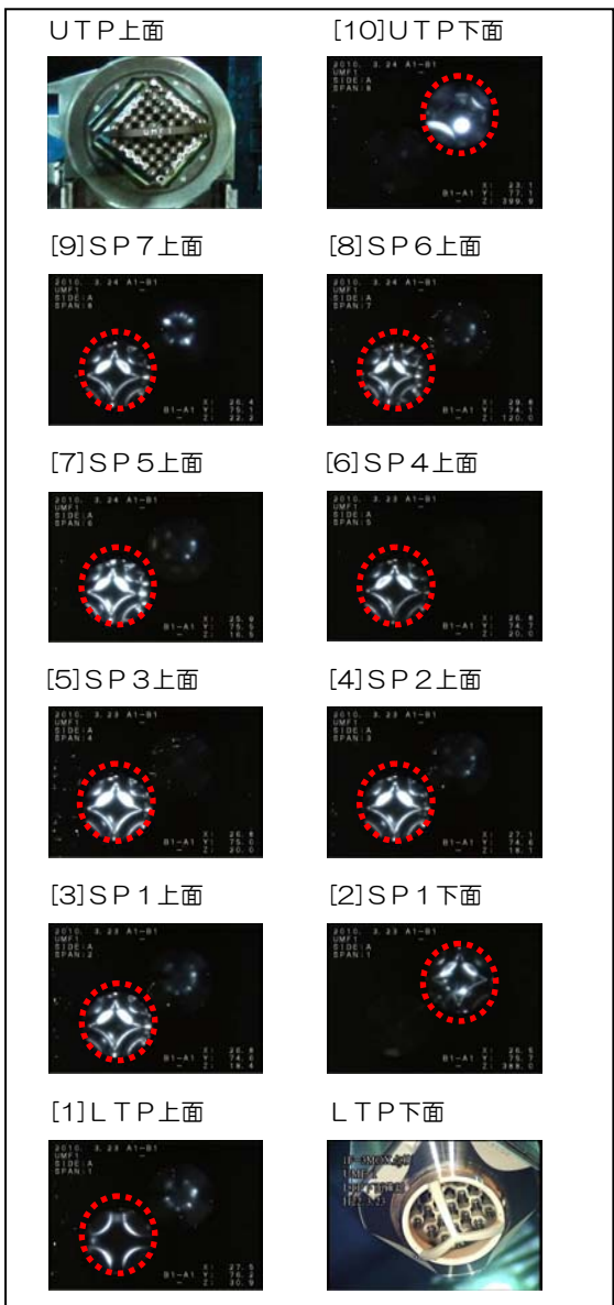
MOX新燃料のファイバースコープ等による観察状況（燃料番号：UMF1の例）
