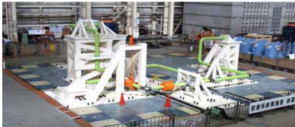
設計手法の確認試験体
