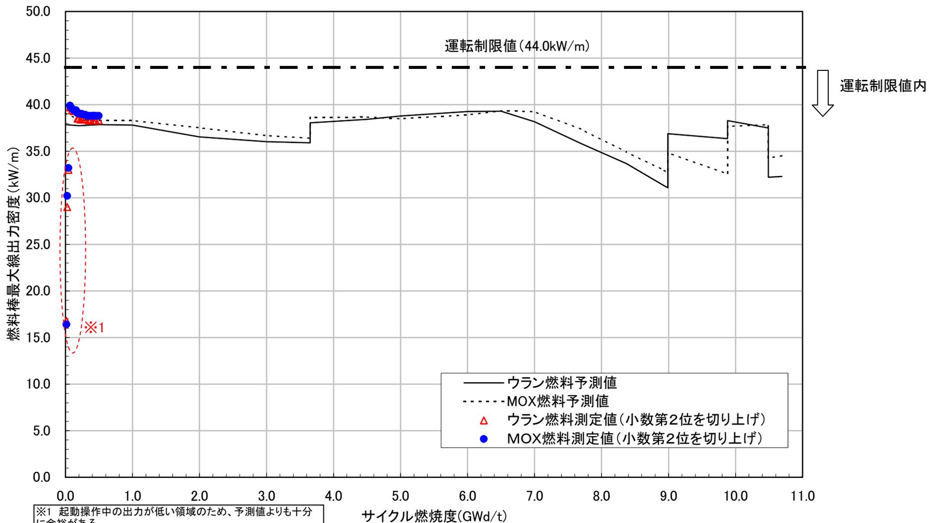
図2 燃料棒最大線出力密度の推移
