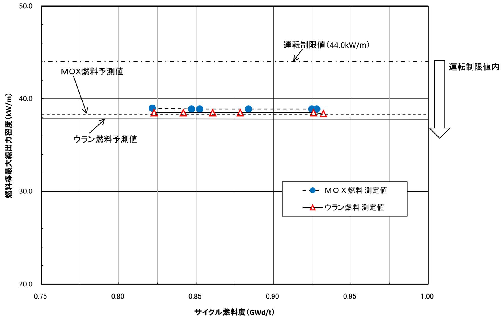
図2 燃料棒最大線出力密度の推移
