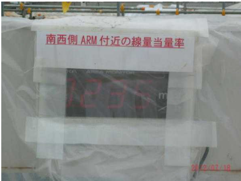
作業現場に数カ所に設置され ている空間線量率計。現在の 被曝量を確認しながら作業に 従事する。 表示は0.235 mSv/h
