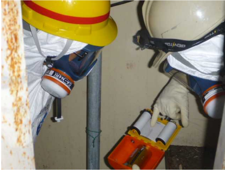
シュミットハンマーによる 測定記録の確認
