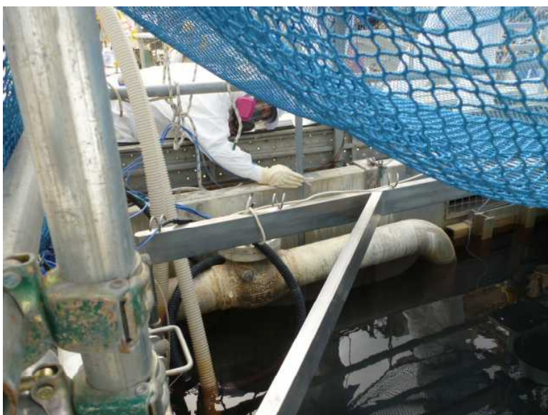
使用済燃料プールの水面から基準面となるプールの縁までの距離測定の状態。 (4号機原子炉建屋5階)
