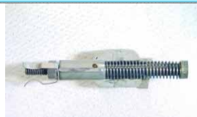
上部タイプレートの孔食の例
