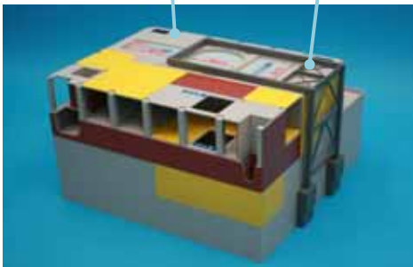
燃料取扱機支持用架構設置(南西面)
